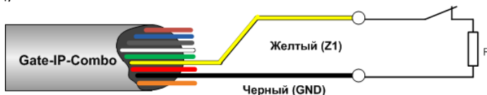
Рис.16. Подключение дверного контакта
